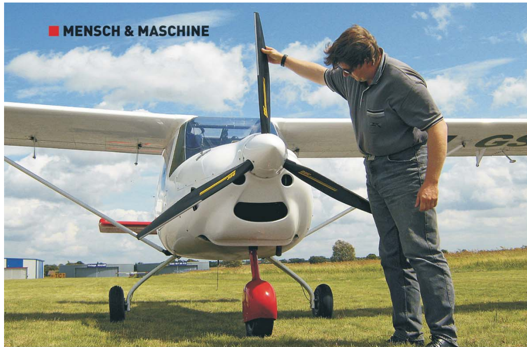
Propeller-Check: Bryan Franken von der Flugschule Aero Light Club prüft den Dreiblatt-DUC. Der CFK-Prop ist nicht verstellbar
