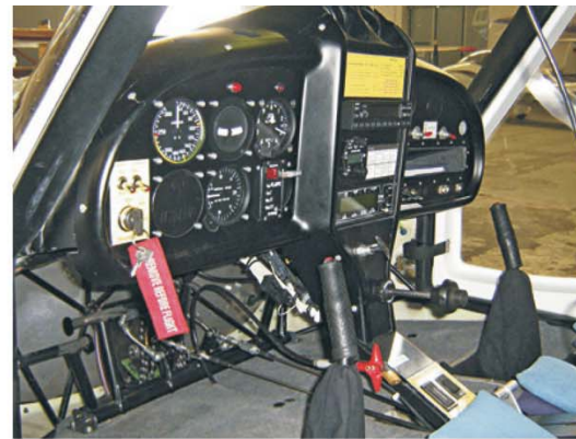
Trotz Uhren modern: Flaps-Schalter mit Stellungsanzeige, LED-Balkenanzeige für die Trimmung auf der Mittelkonsole
