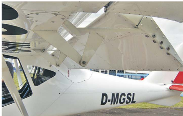
Sehr effektiv: Mit den Fowler-Klappen lässt sich die Fahrt bis auf 60 km/h reduzieren
