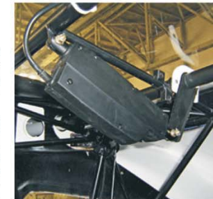
Unterm Kabinendach: Stellmotor für die Landeklappen. Über eine Torsionswelle werden sie in vier Positionen gefahren
