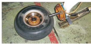
Service-freundlich: Hydraulische Bremse mit konischer Trommel
